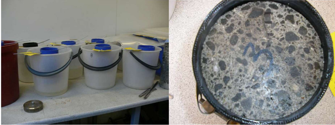
Mynd 1. Uppsetning á lekaprófun t.v. og sprungið steypusýni í hulsu t.h.
